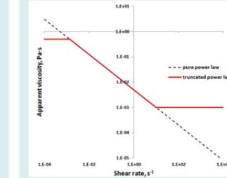
$$\mu_{app} = \begin{cases} \mu_0 & \text{if } \dot{\gamma} < \dot{\gamma}_1 \\ m\dot{\gamma}^{n-1} & \text{if } \dot{\gamma}_1 < \dot{\gamma} < \dot{\gamma}_2 \\ \mu_\infty & \text{if } \dot{\gamma} > \dot{\gamma}_2 \end{cases}$$
